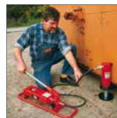
Anheben eines Containers mit Hydraulikzylinder YS-23/160, Hubklaue AYS-23 und Kolbenplatte AYS-232 sowie Handpumpe HPS-2/2 mit Bodenrahmen.
