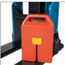
Optional: Wechselakku mit 20 Ah, 30 Ah oder 36 Ah
